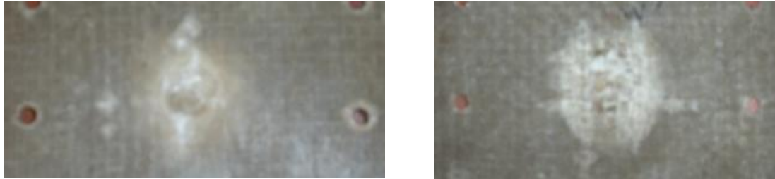
Figura 33. Probeta 2 (MWMW – P) energía de impacto 91,90J.
