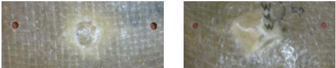
Figura 34. Probeta 3 (MWMW – EP) energía de impacto 51,05J.
