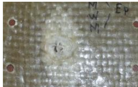
Figura 37. Probeta 4 (WMWM– EP) energía de impacto 51,05J.
