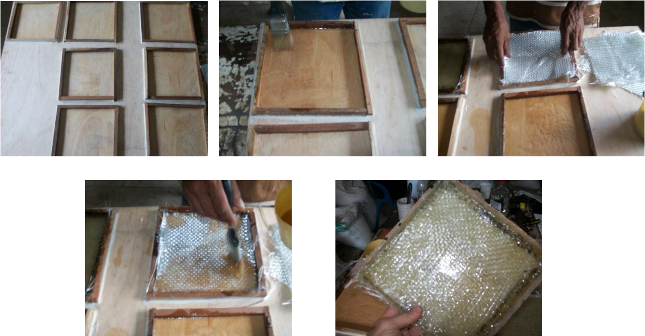
Figura 23. Proceso de construcción de laminados
