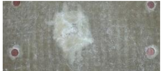
Figura 36. Probeta 3 (MWMW – EP) energía de impacto 91,90J
