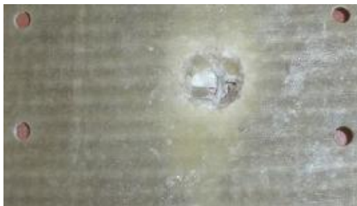
Figura 37. Probeta 4 (WMWM– EP) energía de impacto 51,05J.
