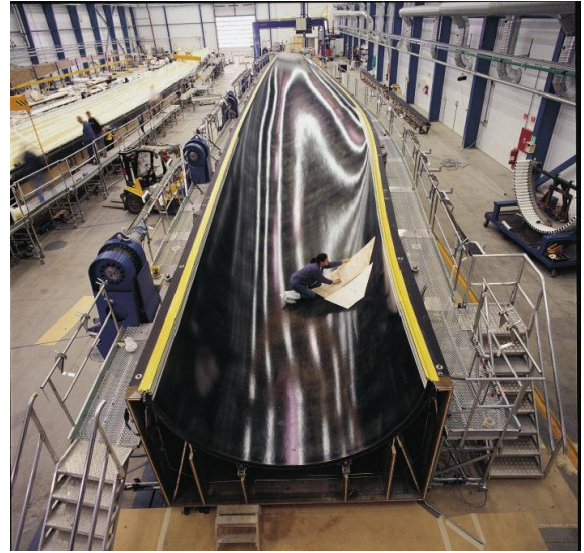
Fuente: Luiz Andre Romariz, "Danoem Placas Laminadas Devido ao Impacto a Baixas Velocidades". Figura 5. Aerogenerador con hélices de fibra de vidrio y manufactura de una hélice.
