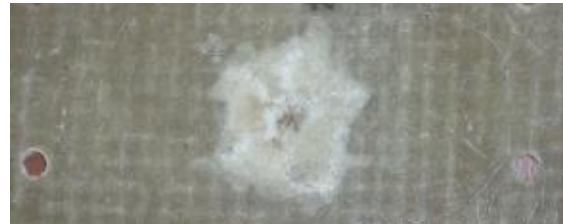
Figura 31. Probeta 2 (MWMW – P) energía de impacto 51,05J.
