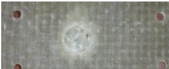
Figura 36. Probeta 3 (MWMW – EP) energía de impacto 91,90J
