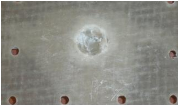
Figura 30. Probetas 1 (WMWM – P) energía de impacto 91,90J.
