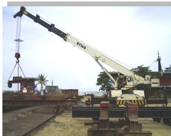
El equipo se utiliza para subida y bajada de materiales hasta de 60 toneladas, además de trabajos en alturas, tales como pintura, *sandblasting*, mecánica, soldadura, etc. y para izajes que requieran de una máxima longitud en el brazo de acción, es decir, lugares muy profundos y/o elevados.
