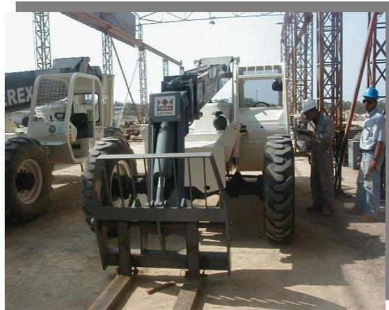
4. MONTACARGAS VR 90B: Este equipo es un montacargas tipo telescópico marca *Ingersoll Rand* modelo VR 90B, con un serial 5210S, posee un motor *Perkins* 4L y tiene una capacidad de levante de 4.5 toneladas (Ver figura 6). Se utiliza para transporte y manipulación de carga y materiales hasta de 4.5 toneladas.
