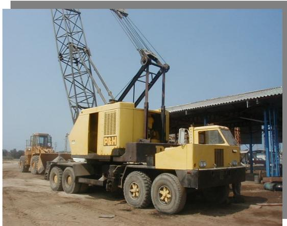
El equipo se utiliza para subida y bajada de materiales hasta de 70 toneladas de peso, es importante su uso en la planta ya que muchos de los trabajos que se realizan consisten en maniobrar ya sea con carga que contenga el buque o con carga que se deba proporcionar para los trabajos que se realizan en él.
