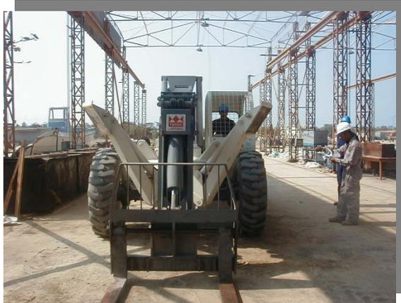
3. MONTACARGAS H 644C: Es un montacargas tipo telescópico marca *Terex Handlers* modelo TH 644 C y con serial 034743, posee un motor *John Deere* JD4045T y tiene capacidad de levante de 3 toneladas. Se utiliza para transporte y manipulación de carga y materiales hasta de 3 toneladas (Ver figura 5).
