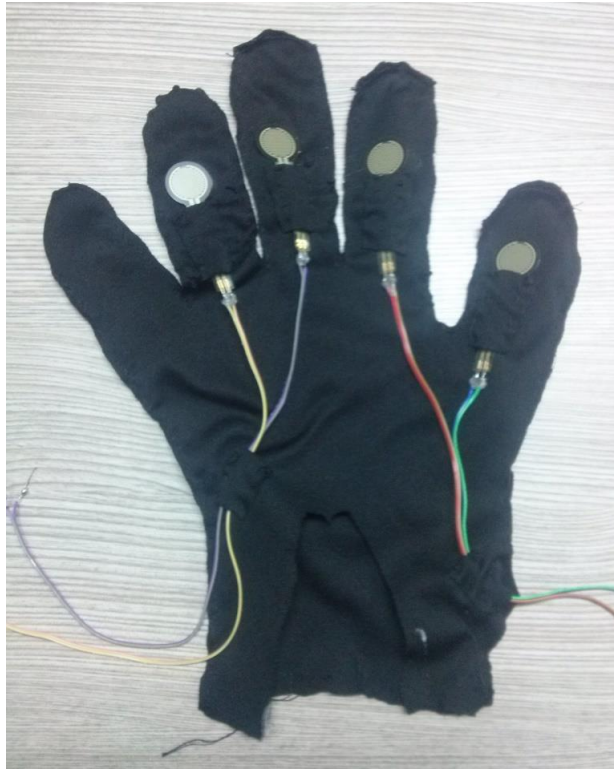
Figura 27: Cableado de sensores entre las telas del guante.
