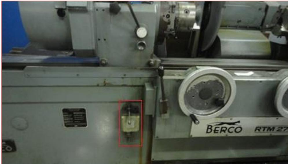
La figura 12 ilustra el indicador de nivel de aceite ubicada en el cabezal portamuela que se encuentra ubicada en la mesa transversal de la máquina rectificadora de cigüeñal.
