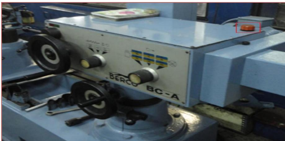
La figura 21 ilustra el indicador de nivel de aceite del cabezal principal de la máquina mandrinadora horizontal de cojinetes de bloques y árboles de levas.
