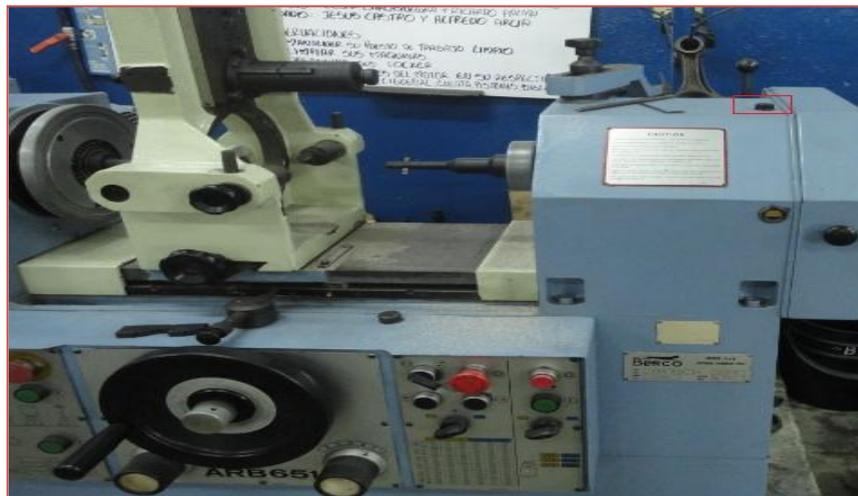
Las mirillas de nivel de aceite del equipo se pueden apreciar en la figura 30 resaltadas en los recuadros de color rojo.
