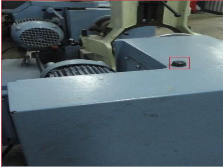
La figura 29 muestra el punto de lubricación del cabezal de mandrinado y se observa el mando mecánico y eléctrico de la mesa de la mesa longitudinal.
