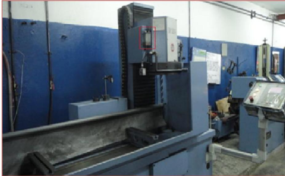
Los depósitos de aceite que lubrican los rieles de la mesa de trabajo del equipo se muestran en la figura 18 .
