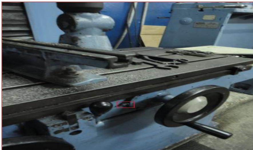
La bomba de lubricación de guías verticales del cabezal de la mandrinadora de bloques de cilindros se ilustra en la figura 25.
