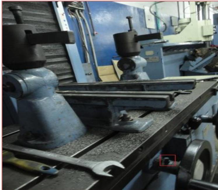
La figura 24 muestra punto de lubricación de los volantes de avance longitudinal, transversal y guías de la bancada.
