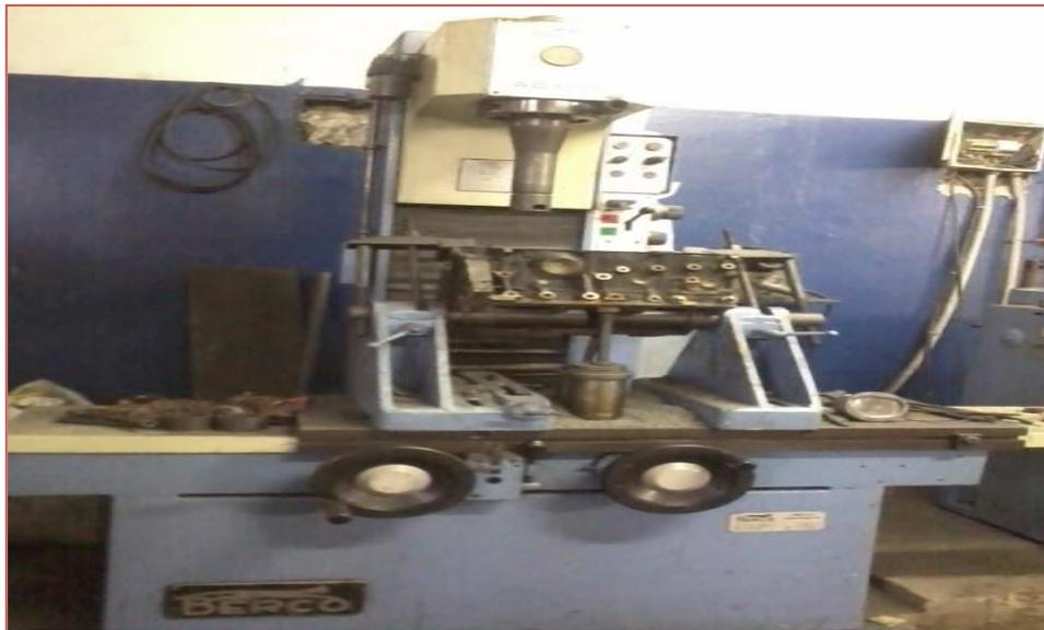
La línea de rectificado de la empresa presenta dos máquinas mandrinadoras de bloques de cilindros una de las cuales es neumática. La máquina mandrinadora neumática difiere en la máquina mandrinadora convencional ya que el movimiento vertical del mandril ocurre por presión de aire y este equipo se utiliza para motores de buses y camiones.
