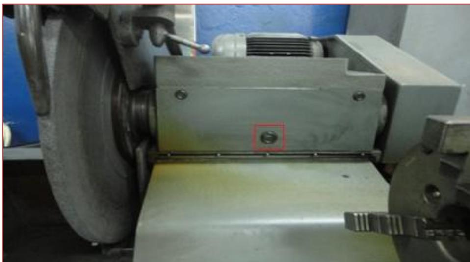
El cabezal portamuela posee un punto de lubricación como se muestra en la figura 13.
