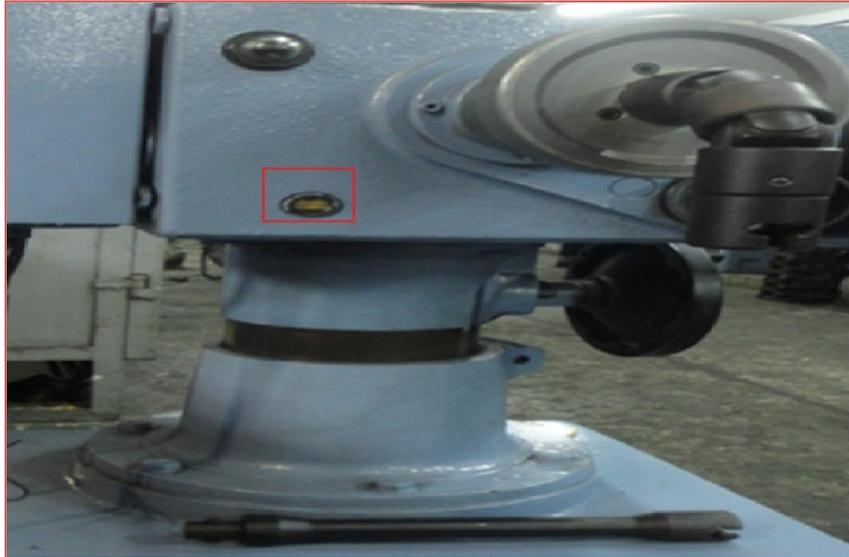
Se observa en la figura 22 las bombas de lubricación que se encargan de lubricar los soportes de la barra de alineamiento del equipo.
