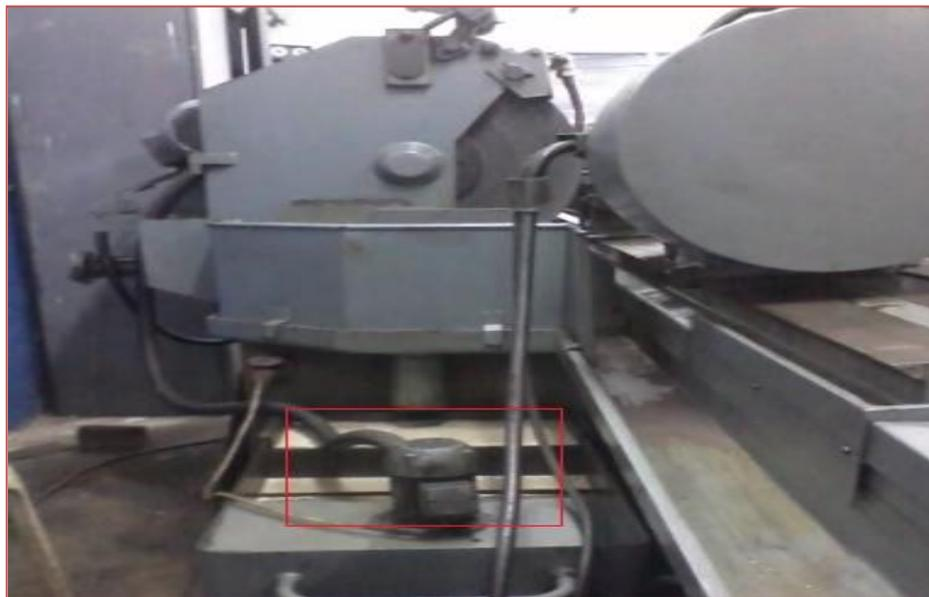
La figura 15 ilustra el sistema hidráulico el cual tiene como función accionar la bomba de lubricación de la mesa transversal y suministrar aceite a presión a las bombas de lubricación de las mesas; además, envía aceite a presión al cilindro hidráulico que controla el avance de la mesa transversal que se muestra en la figura 16.
