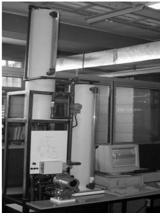
Adicional al Transmisor de presión diferencial que lee el nivel del tanque1 y lo convierte en una señal de 4mA a 20mA, y a la electroválvula que dependiendo el nivel de tensión que tenga en su entrada permitirá mayor o menor flujo de agua hacia el tanque 1, también se plantea colocar para la seguridad del prototipo dos finales de carreras en cada uno de los tanques.
