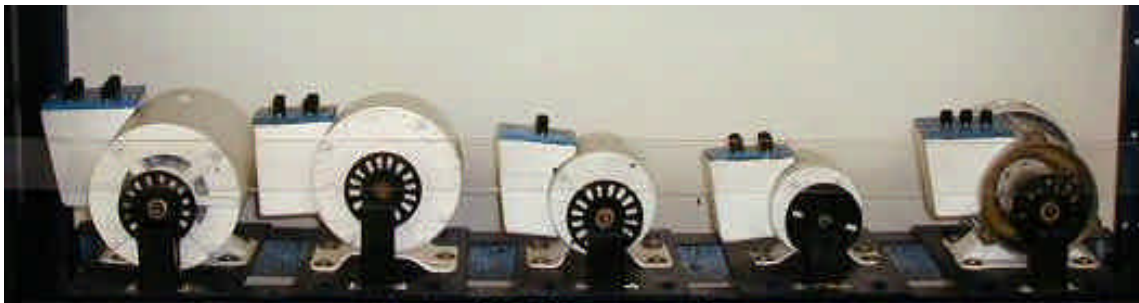
Figura 11. Grupo de motores monofásicos
