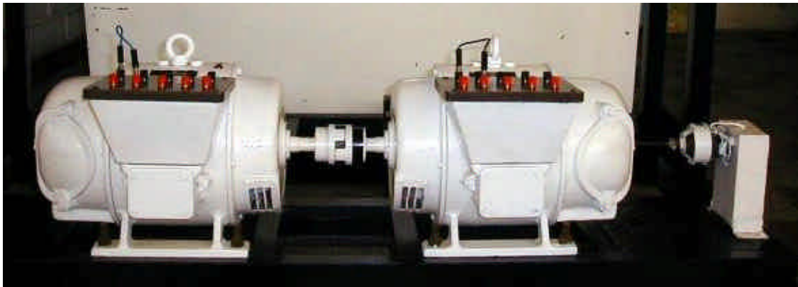
Figura 10. Grupo motor- generador- tacogenerador de corriente continua
