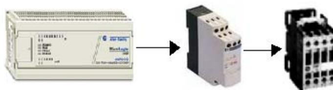
Figura 55. Configuración de salidas del PLC por relés.
