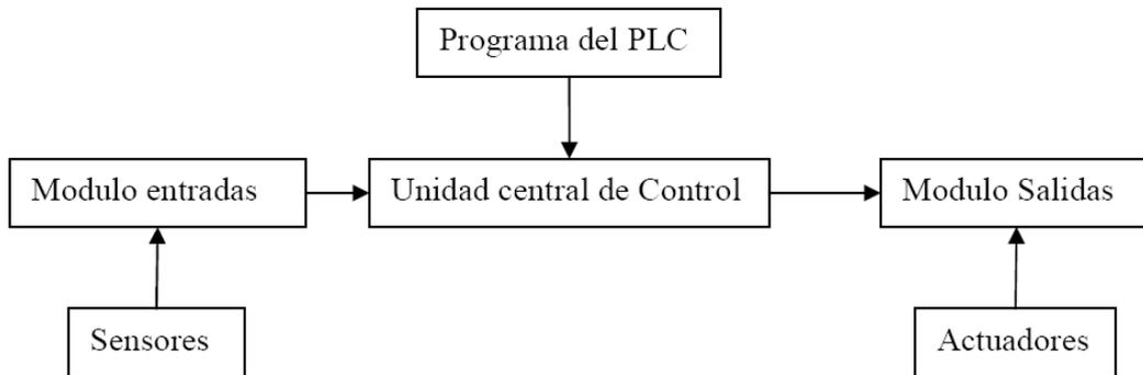
**Figura 13. Componentes del sistema de un PLC**
