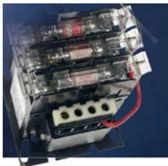
**Figura 56. Transformador de Control.**
