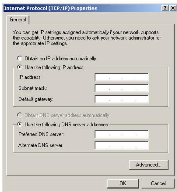
Configure la información de la dirección IP para cada PC según la información en la tabla. Observe que la dirección IP de cada PC se encuentra en la misma red que el gateway por defecto, que es la interfaz de Ethernet del router conectado. El gateway por defecto se requiere en las redes de área local que están conectadas a un router.
