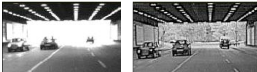
Figura 14 Imágenes con cámara CCD y CMOS respectivamente
