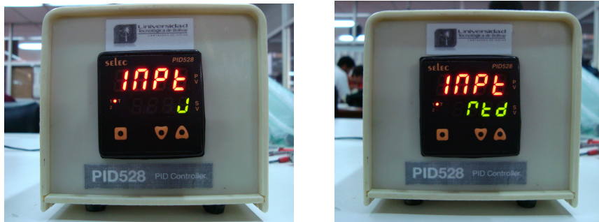
Figura 19. Selección del sensor (TC/RTD)
