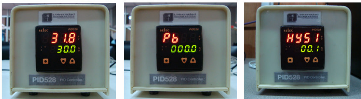
Figura 20. Ajuste de Set point, Pb e Histéresis
