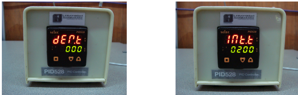
Figura 25. Configuración de bandas derivativa e integral para Control Proporcional Integral.
