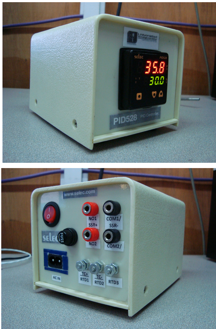
Figura 10. Vista general del Panel de control principal. Este es el sistema que comprende al controlador Selec® PID528 y sus terminales de conexión.
