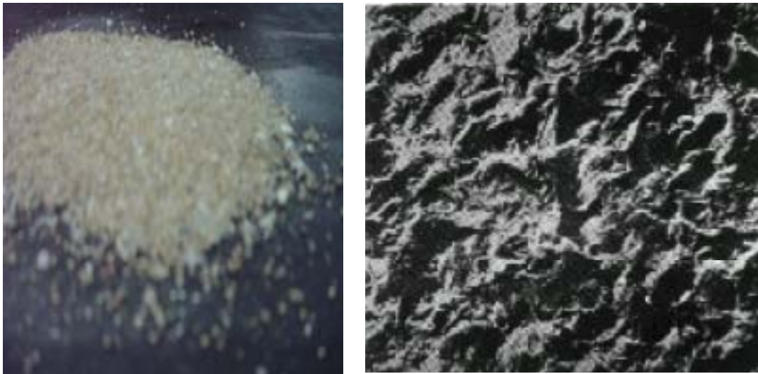
Superficie chorreada con abrasivo angular
