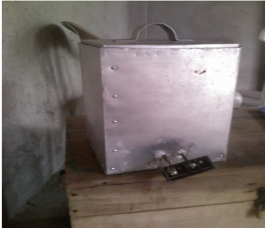
Ilustración 5-3 Prototipo para medir la conductividad térmica
