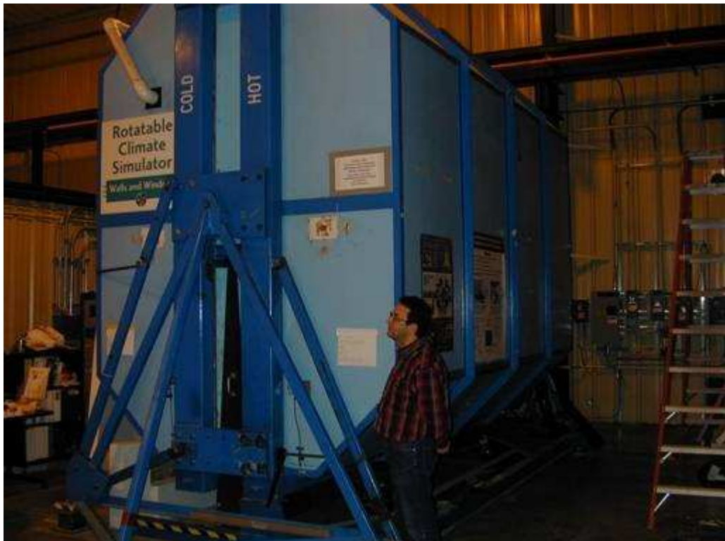
Ilustración 3-1 Caja Caliente rotable con guarda (UMASS)
