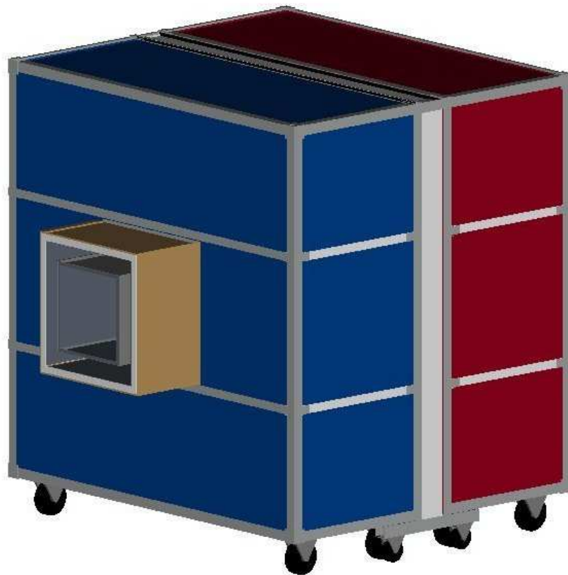
Ilustración 3-3 Hot Box Estática
