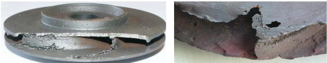
Ilustración 3-2 Daño en impelentes por cavitación
