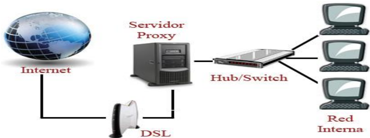
Figura 14. Esquema Básico de un Proxy.
