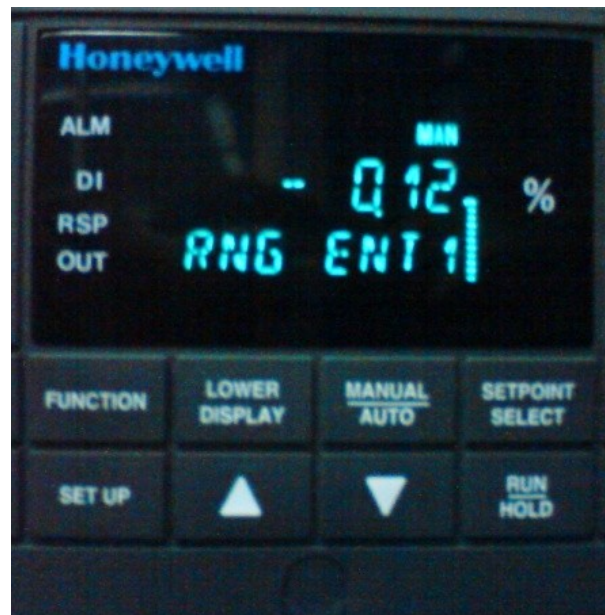
Figura 4 Controlador Digital Universal (UDC) Honeywell
