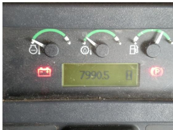
Horómetro en funcionamiento
