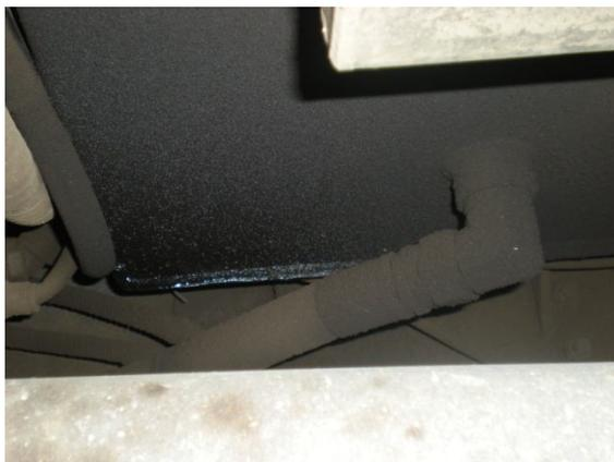
Fugas de aceite tanque hidráulico.
