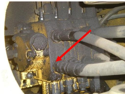
Fugas de aceite bomba hidráulica.
