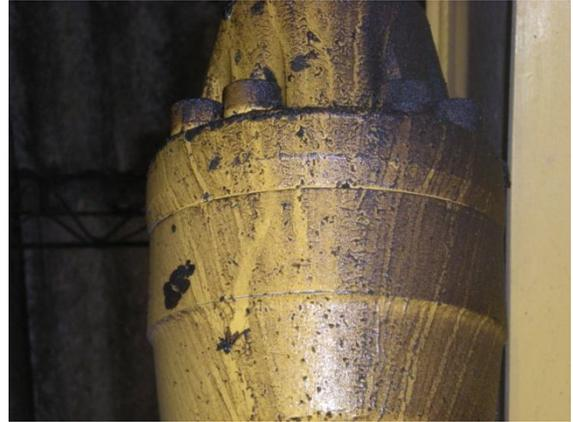
Fugas de aceite en cilindros hidráulicos.
