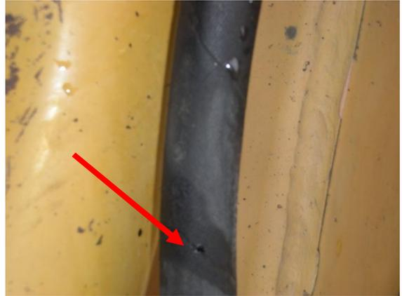
Desgaste en mangueras del sistema hidráulico del cucharón.
