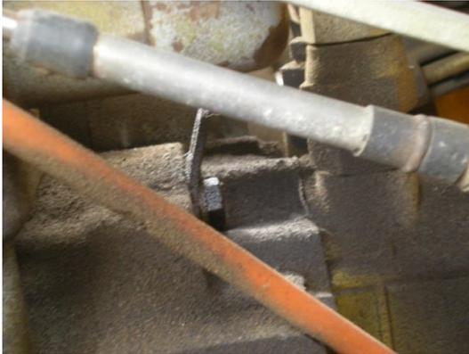
Fugas de aceite en la bomba hidráulica.
