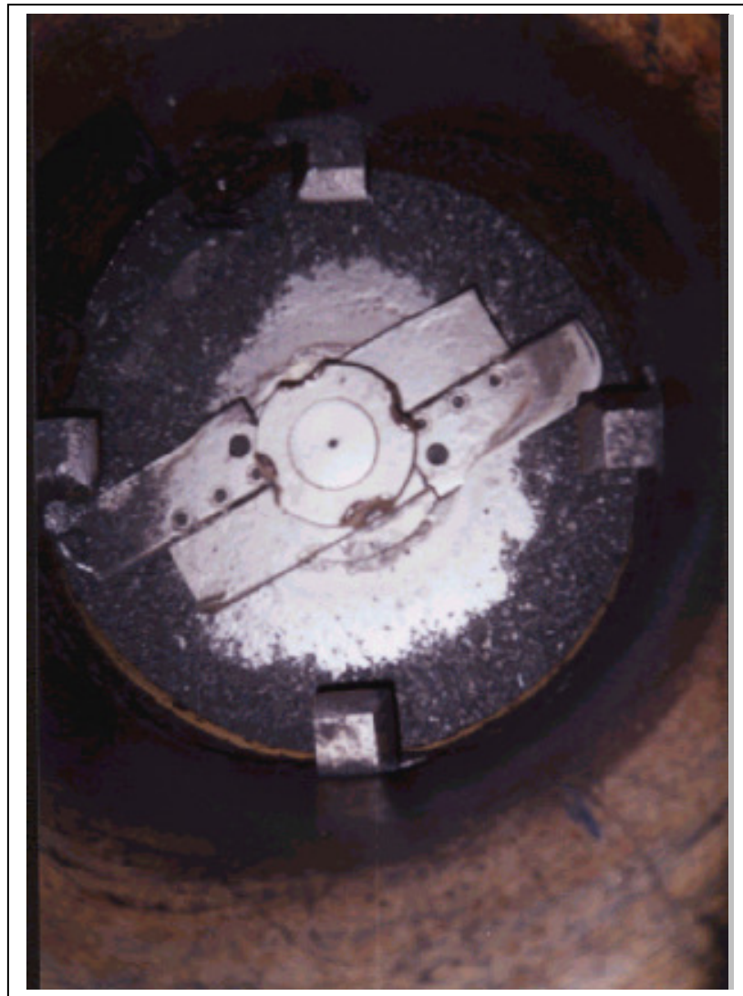
Figura 21. Cuchillas móviles acopladas al eje
