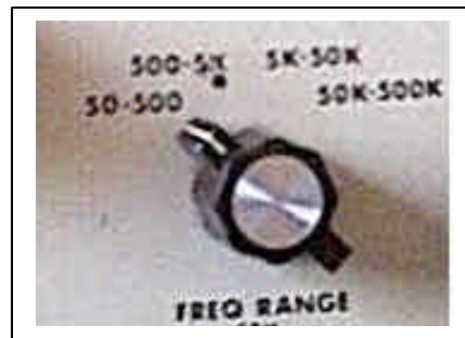
Figura 5.6 Selector de rangos de frecuencias
