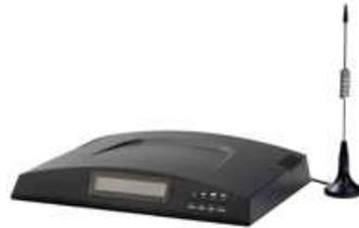
El cliente recibe el servicio telefónico a través de terminales conectados por radio a una red de estaciones. Los terminales WLL pueden ser microteléfonos que permiten grados variables de movilidad. Pueden constar de teléfono integrado a un equipo para uso en el escritorio o pueden ser unidades solas o de varias líneas que se conectan con unos o más teléfonos estándares.
