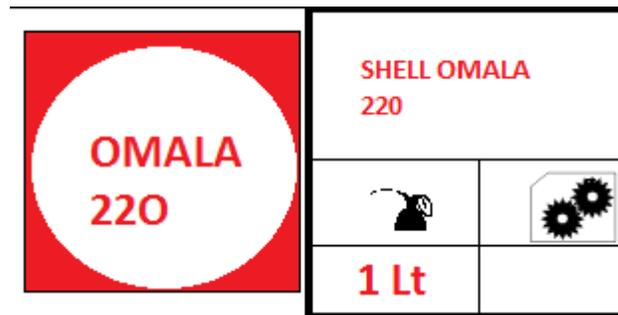
**Figura 9:** Placa para motorreductor
