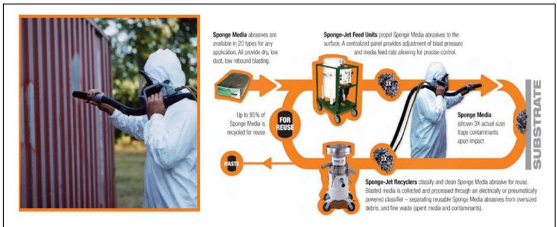
**Granallado:** Técnica para la preparación de superficies metálicas utilizando como abrasivo partículas de oxido de aluminio con el fin de dar perfil de anclaje para la aplicación de pintura.
