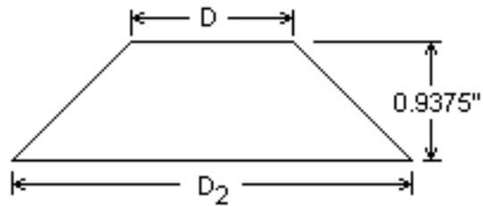
$D = 1,5d = d_w$  (Diámetro de la cara inferior de la cabeza del tornillo)
