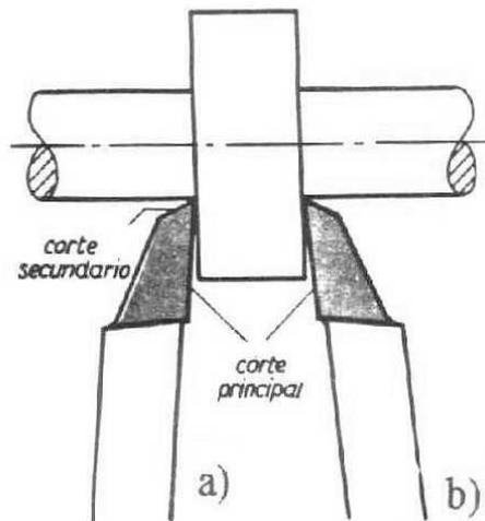
Figura 22. Útiles de corte lateral. a) útil de corte lateral a la izquierda, b) útil de corte lateral a la derecha.
