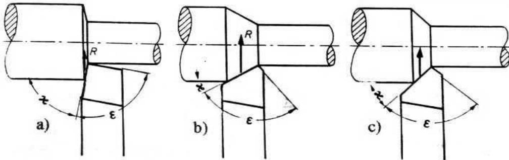
Figura 16. Ángulos de posición y de la punta en el útil de torno.  $\chi$ ) ángulo de posición,  $\epsilon$ ) ángulo de la punta, R) presión o esfuerzo ejercido contra el eje de giro, a) ángulo de posición grande, b) ángulo de posición pequeño, c) ángulo de posición normal.
