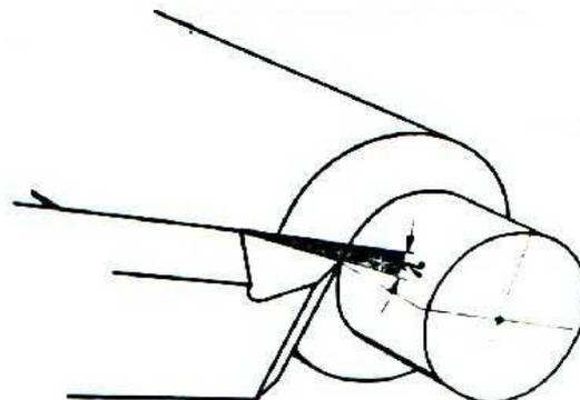
Figura 17. Ángulo de inclinación  $\lambda$  en un útil de desbastar
