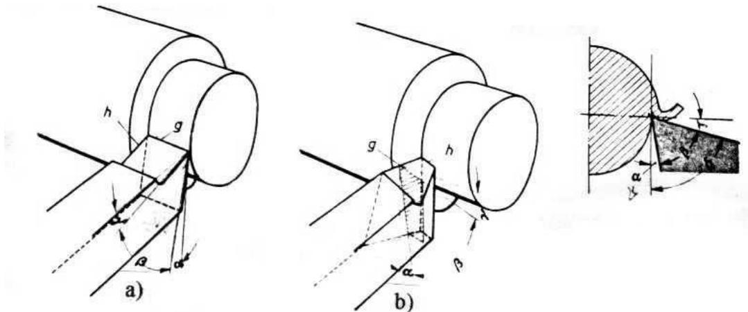
Figura 15. Cortes y ángulos en el útil de torno. g) corte principal, h) corte secundario,  $\alpha$ ) ángulo de incidencia,  $\beta$ ) ángulo de filo,  $\gamma$ ) ángulo de ataque,  $\delta$ ) ángulo de corte
