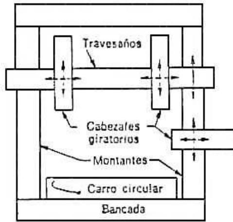
Figura 13. Componentes básicos de una alesadora vertical
