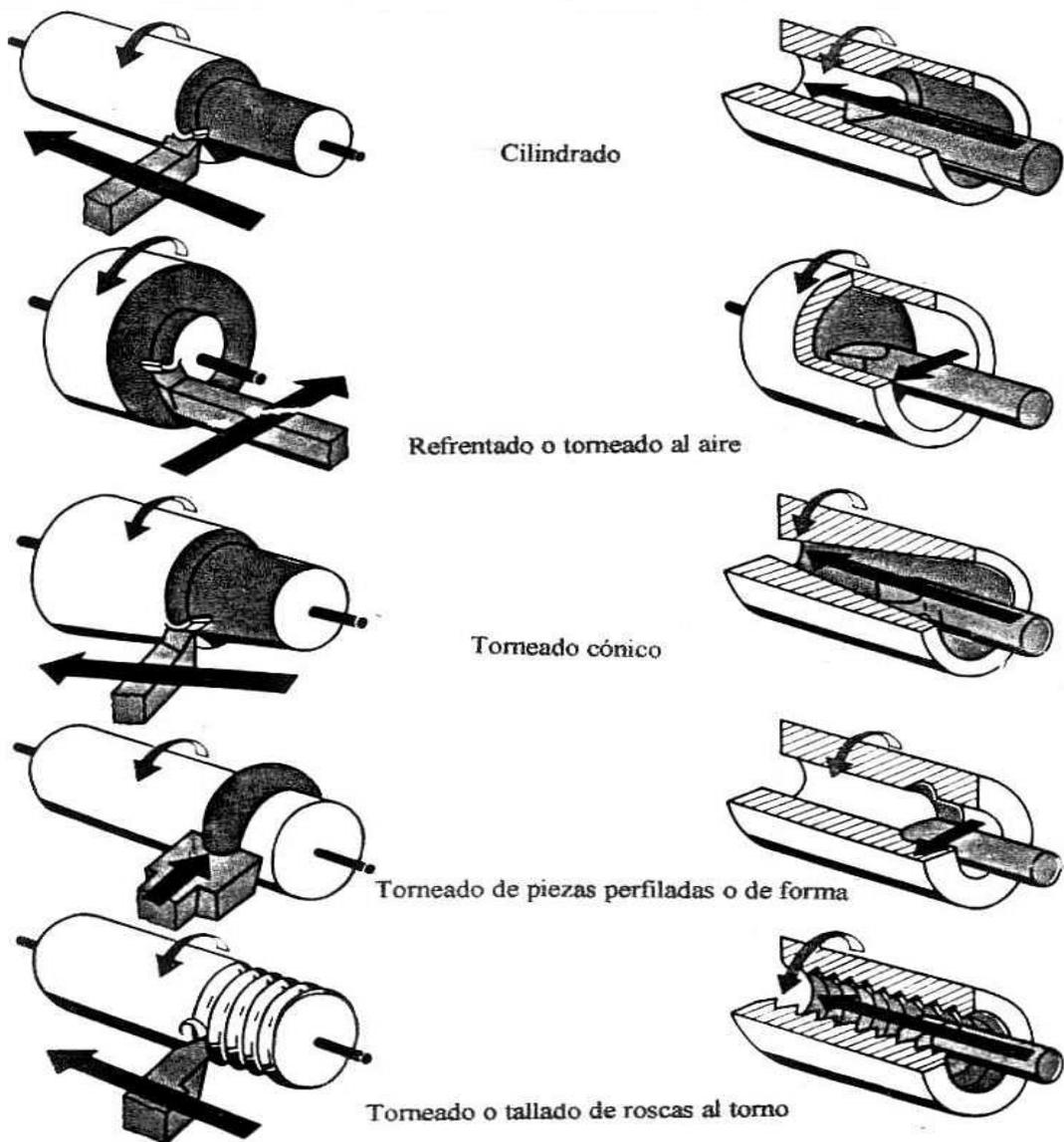
Figura 18. Procedimientos de torneado
