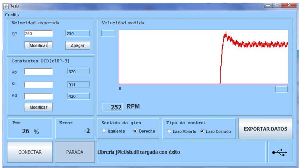
Figura 29. Prueba de Operación
