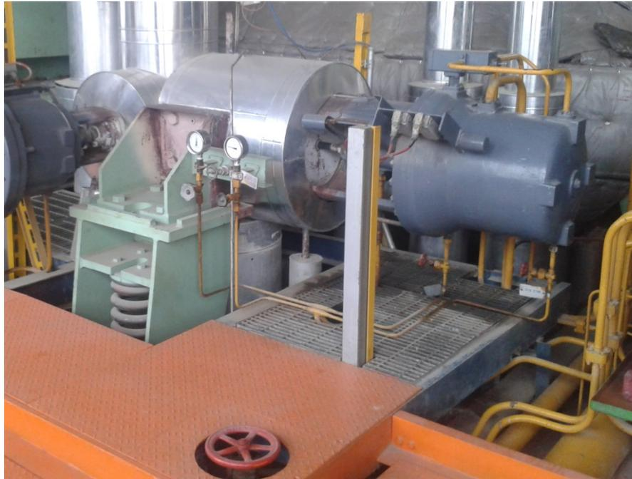
La válvula de cierre rápido se abre por vía oleo hidráulica y se cierra por la acción de un resorte.
