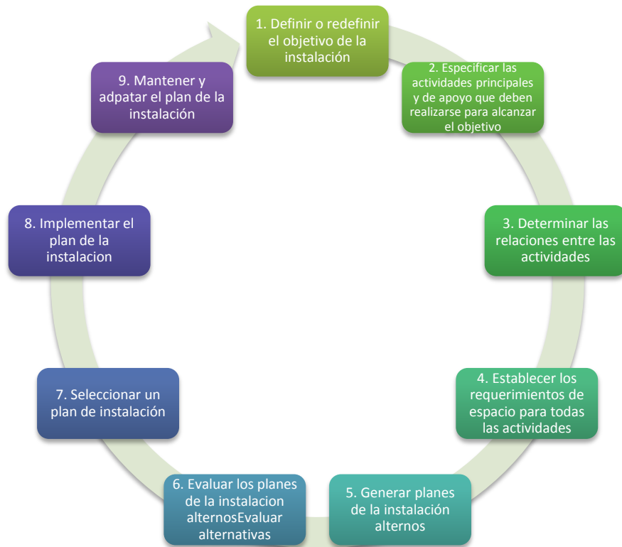
Figura 4.2. Proceso de planeación de instalaciones.
