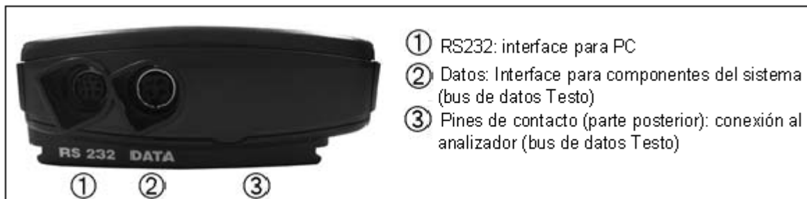
Figura 13. Conexiones/interfaces de la Unidad de Control 89
