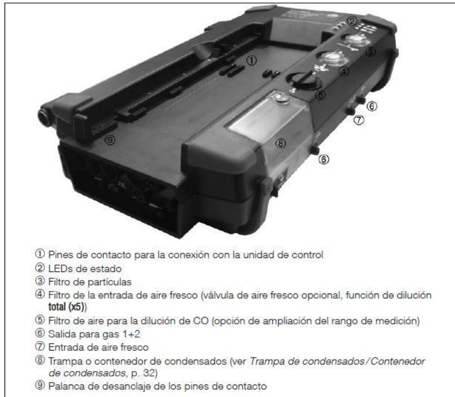
Figura 14. Analizador de productos de la combustión 90
