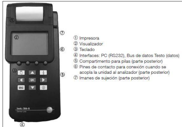
Figura 12. Unidad de Control 88
