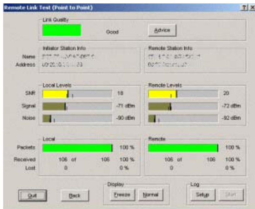
Figura 14. Enlace bueno, con relación señal a ruido aceptable en los extremos
