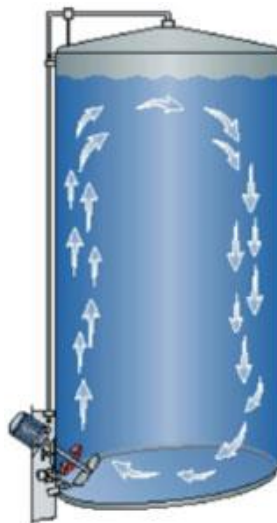
Figura 5. Esquema básico de calentamiento de la leche
