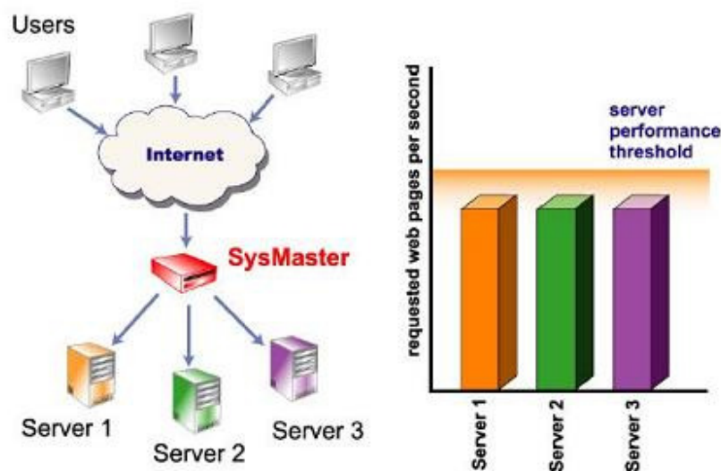
Figura 2.3. El mismo esquema anterior aplicando el Load Balancer de Sysmaster.
