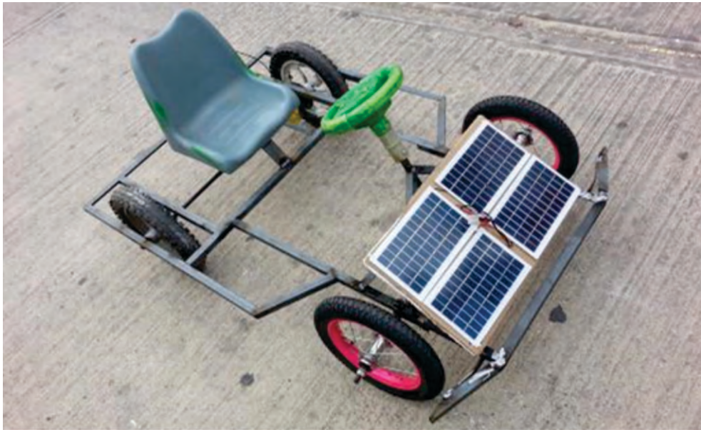
Figura 2. Carro Solar 1- sistema eléctrico y paneles solares
