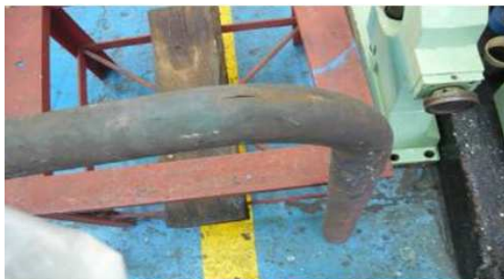
Ilustración 12. Tubo del sobre calentador secundario fisurado.
