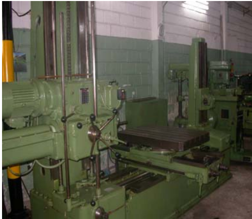
Figura N° 16 Máquinas de apoyo de la línea de producción convencional “Mandrinadora Con Ayuda Numérica”
