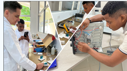
Figura 5. Evidencias de pruebas de eficiencia de celdas PEM con temperatura ambiente y montaje de sistema de control de temperatura en el horno para pruebas Fuente: Elaboración Propia
