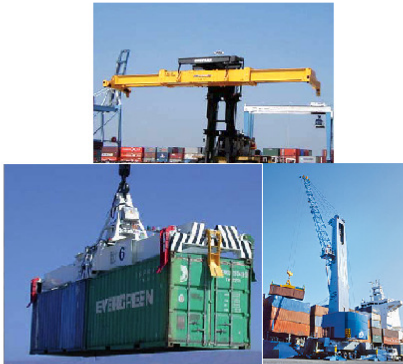
Figura 72. Equipos para carga de contenedores usando spreader.
