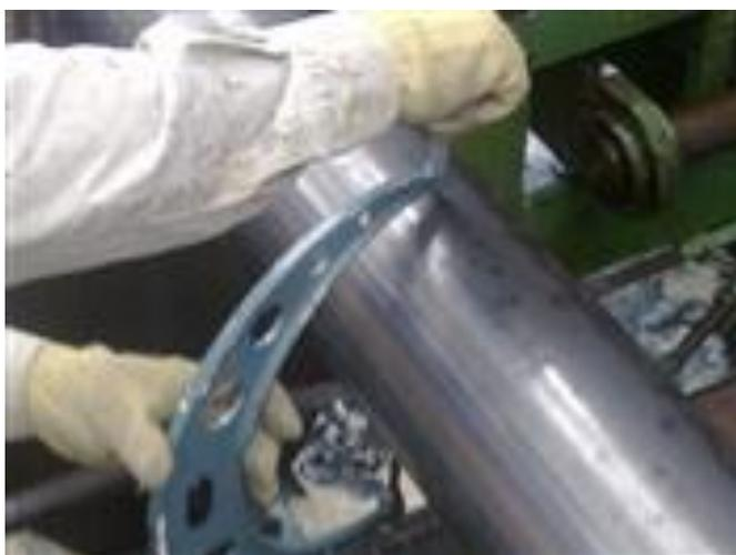
**Figura 17 . Medición vertical de diámetro -micrómetro**
