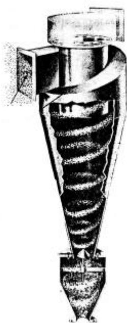
**Figura 45. Ciclón con entrada helicoidal**
