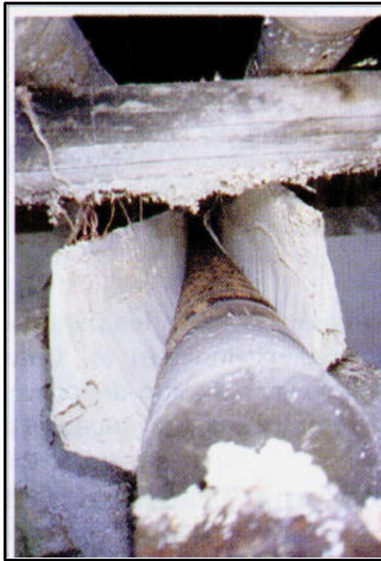
**Figura 16. Colado continuo de la masa rallada, empleando un tornillo sin fin**
