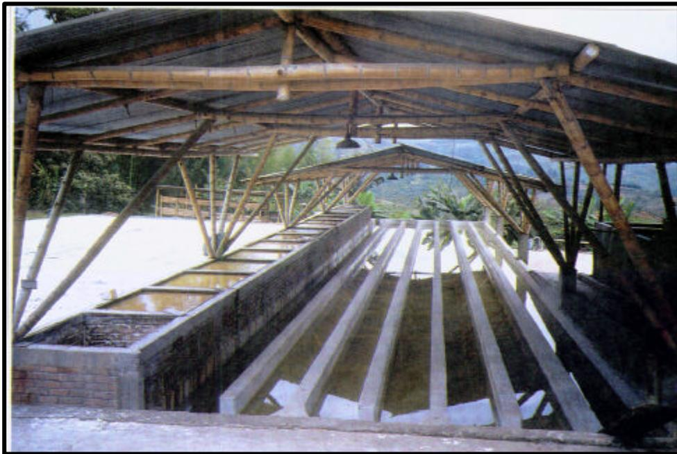
**Figura 21. Sistema de siete canales para la sedimentación del almidón a partir de la lechada de yuca**
