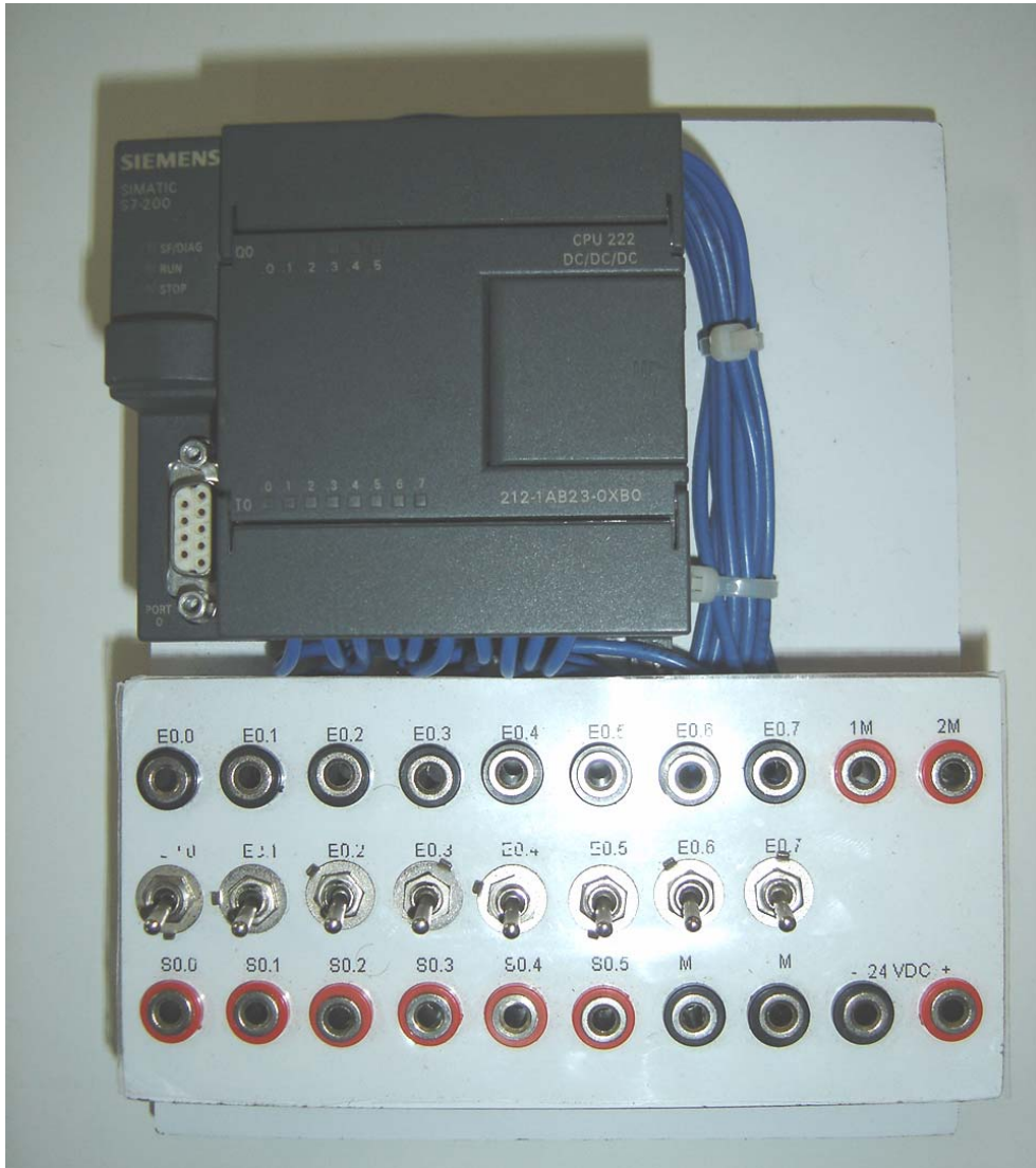
Foto del PLC SIMATIC S7-200
