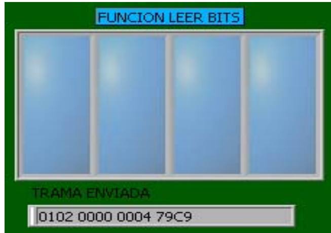
Figura 37. Trama enviada Función 02H.
