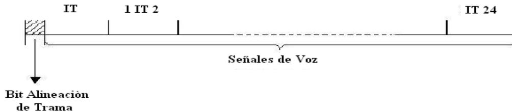
*Figura 3.23: Estructura de la trama MIC24 (T1)*
