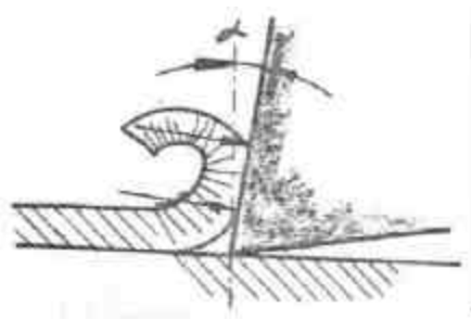
Figura 9. Influencia del ángulo \alpha de la herramienta en la potencia de corte.
