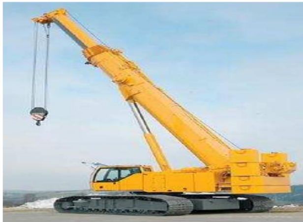
Figura 10: Grúa montada sobre una oruga.
