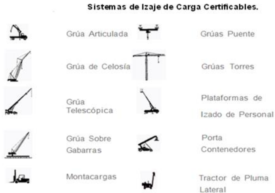
Figura 26: Diferentes sistemas de izajes de cargas certificables Fuente norma ASME 30.5
