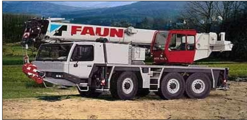
Figura 8: Grúa montada sobre un camión.
