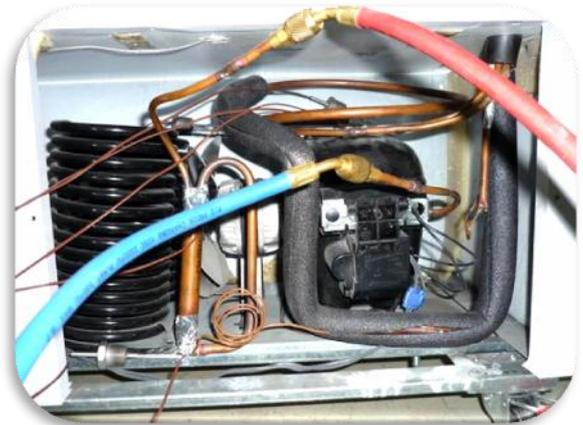
**Figura 56.** Ubicación de sensores para la medición de presión en los lados de alta y baja.
