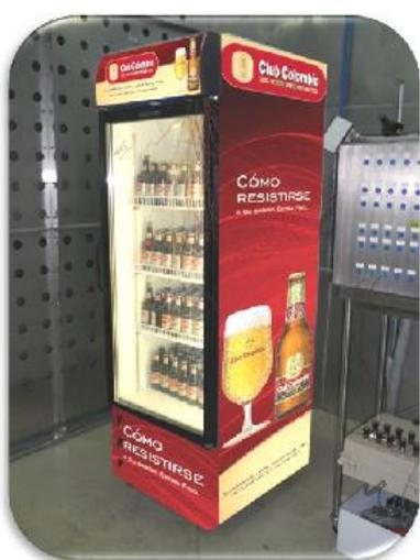
Ahora analicemos la grafica (*ver figura 68*) de la segunda prueba de temperatura: *Half Reload* (media recarga). Esta prueba consiste en retirar (posterior al tiempo de Pull Down), la mitad del producto refrigerado y reemplazarlo, por otra mitad que se encuentre a temperatura ambiente (40.5°C). Para esta prueba, a diferencia de la anterior, el tiempo estipulado es de 17 horas o menos, en el cual el equipo debe alcanzar la temperatura requerida (-4.5°C).
