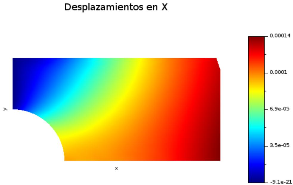
Figura 10: Desplazamientos en  $x$  calculados por MLPG.
