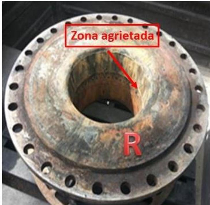
**Figura 10.** Vista por la zona de reacción. Evidencia de grieta.
