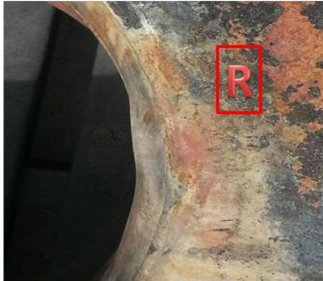
**Figura 11.** Evidencia de deformación plástica hacia el interior del reactor.
