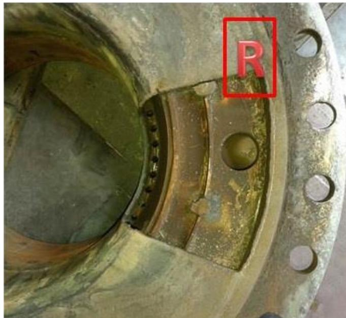
**Figura 12.** Zona de extracción con la grieta.
