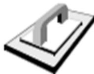
Para preparación de superficies lisas con mezclas de cemento y mezclas de estuco.
