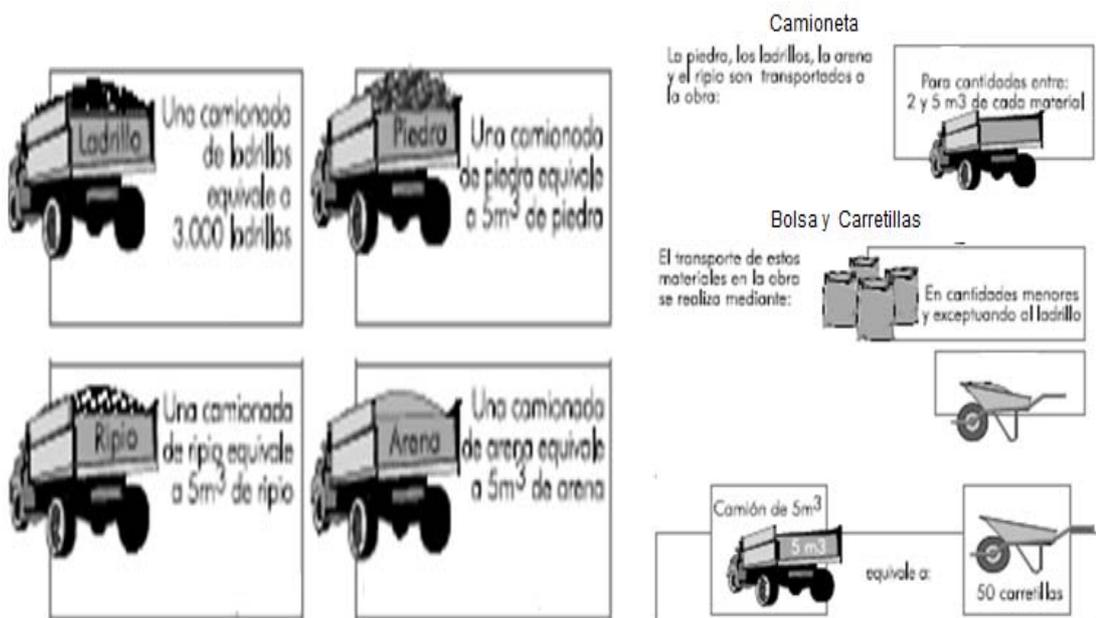
**Cada camión tiene una capacidad máxima de 5m<sup>3</sup>**
