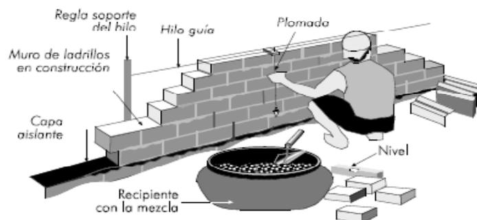
Ilustración 44 Verificación de la pega de bloques Disponible en: <http://www.cedure.org/Manual-de-Autoconstruccion.html>
