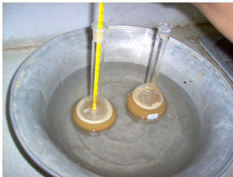
Figura 26. Ensayo de Gravedad Específica.
