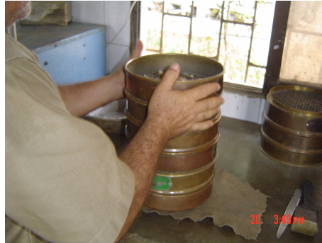
Figura 22. Verificación de gradación escogida.
