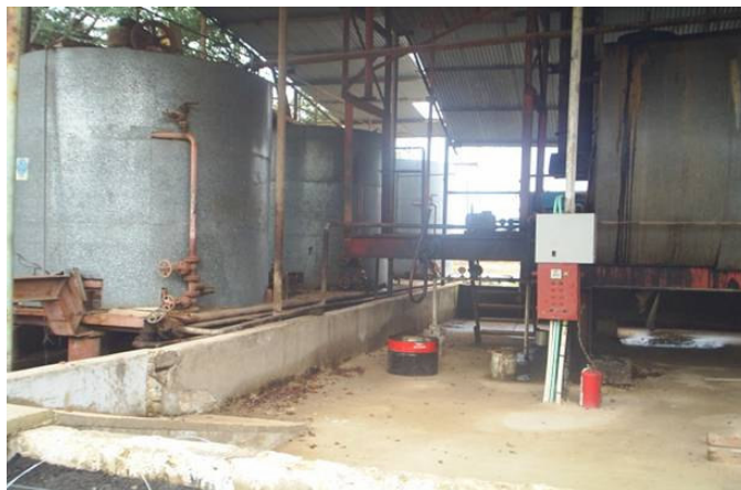
Figura 11. Tanques de almacenamiento de asfalto
