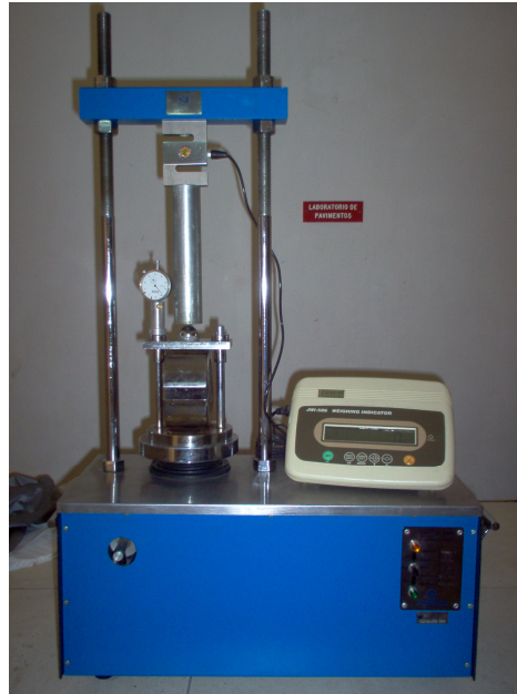
Figura 28. Máquina Marshall para Estabilidad y Flujo.
