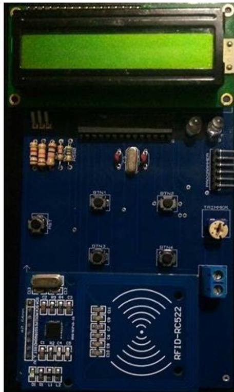
Figura 2.15: Dispositivo programador soldado antes de colocarle la carcasa
