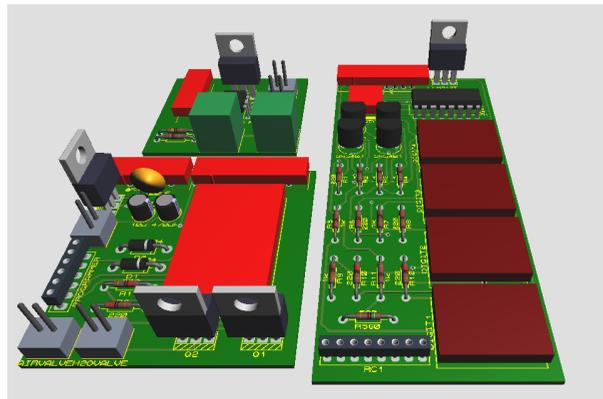
Figura 2.33: Imagen en 3D de los módulos del dispositivo controlador de válvulas.
