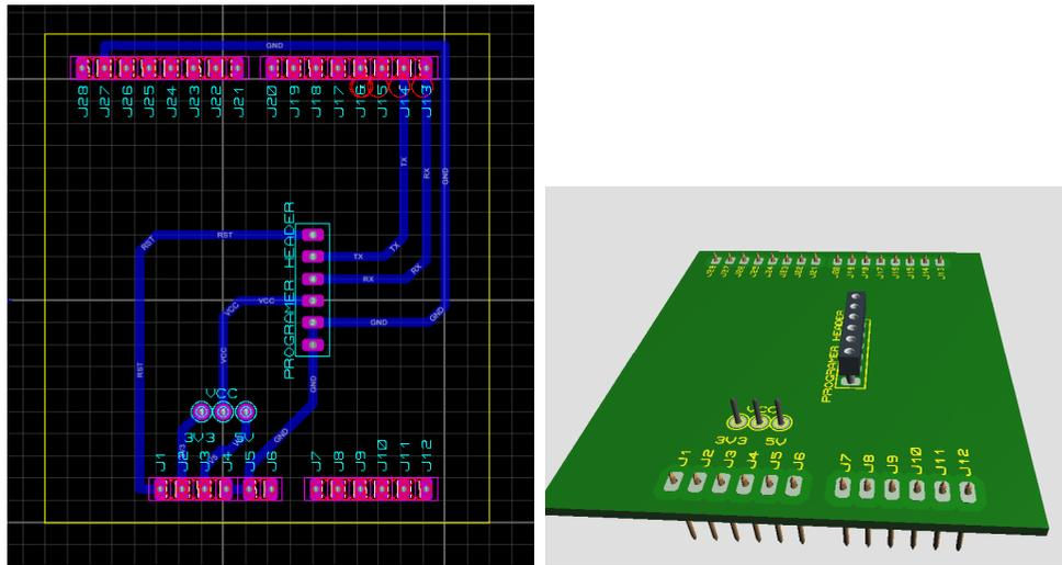
(a) Diseño de PCB de Shield Programadora (b) Diseño de en 3D de Shield Programadora
