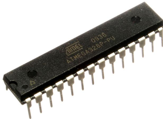
Figura 2.9: ATMega328P - PU
