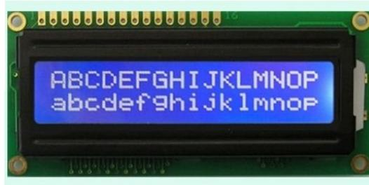
Figura 2.12: Pantalla LCD 16x2
