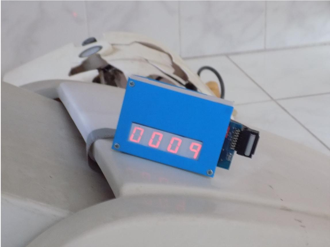
Figura 2.40: Bloque de dispositivo que muestra el tiempo restante.
