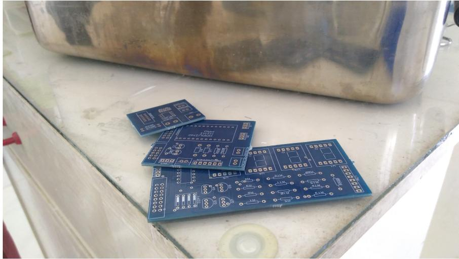
Figura 2.34: PCB fabricadas
