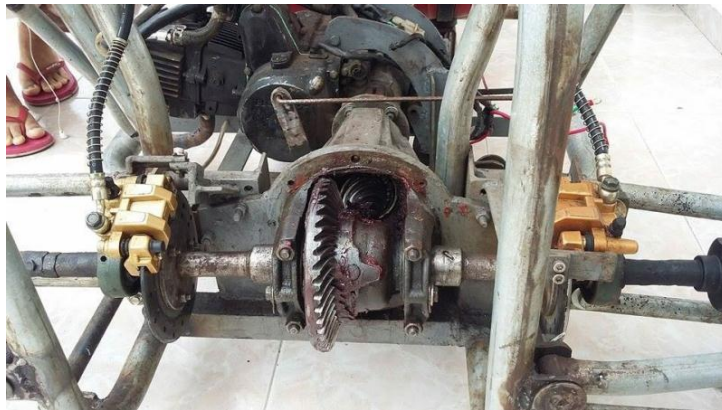
Figura 69: Instalación de diferencial al chasis.
