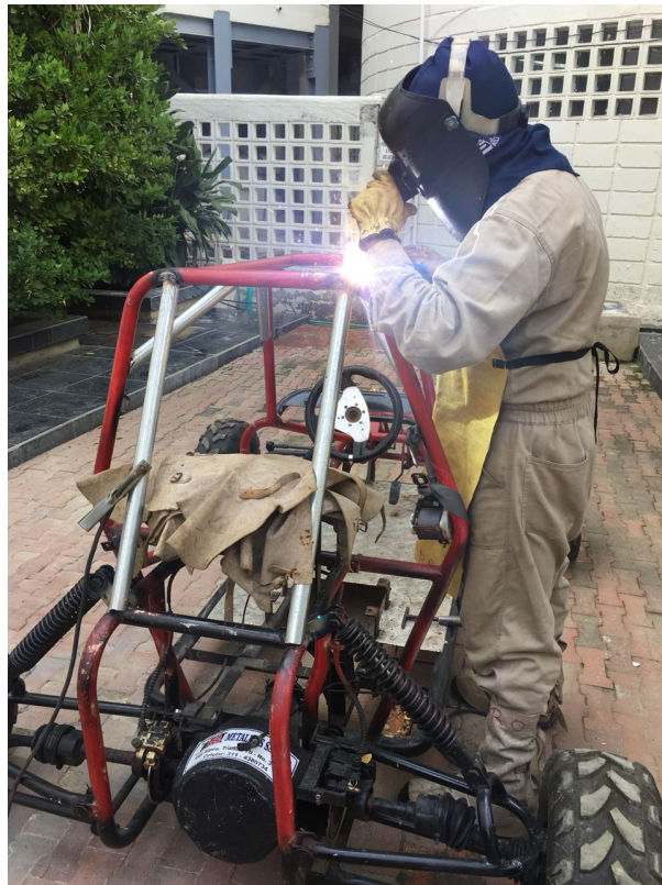
Figura 149: Soldadura trasera del chasis
