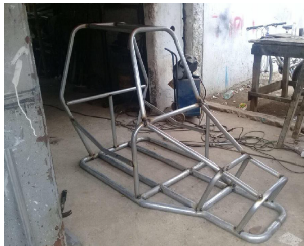
Figura 138: Chasis tubular construido.
