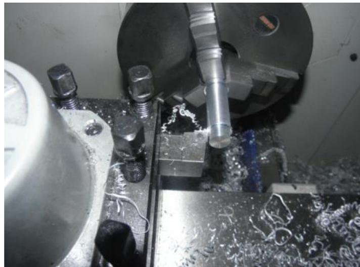
**Figura 3.23.** Fabricación de los ejes de las articulaciones.
