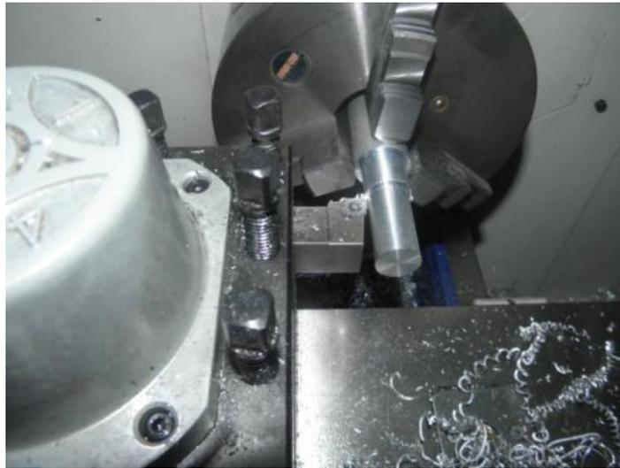
**Figura 3.24.** Fabricación de los ejes de las articulaciones.
