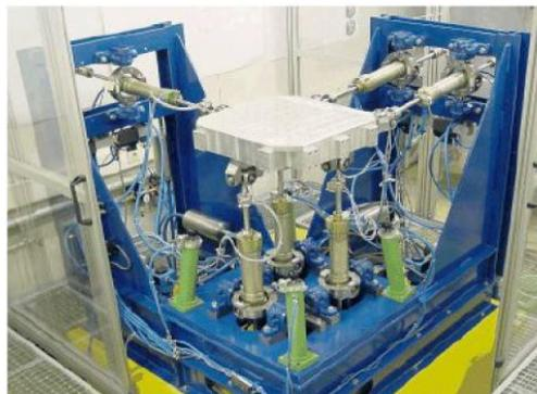
**Figura 1.5.** Multi-Axis Simulation Table (MAST) referenciada por V.E. Gough.
