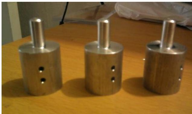
**Figura 3.28.** Acoples de los motores.
