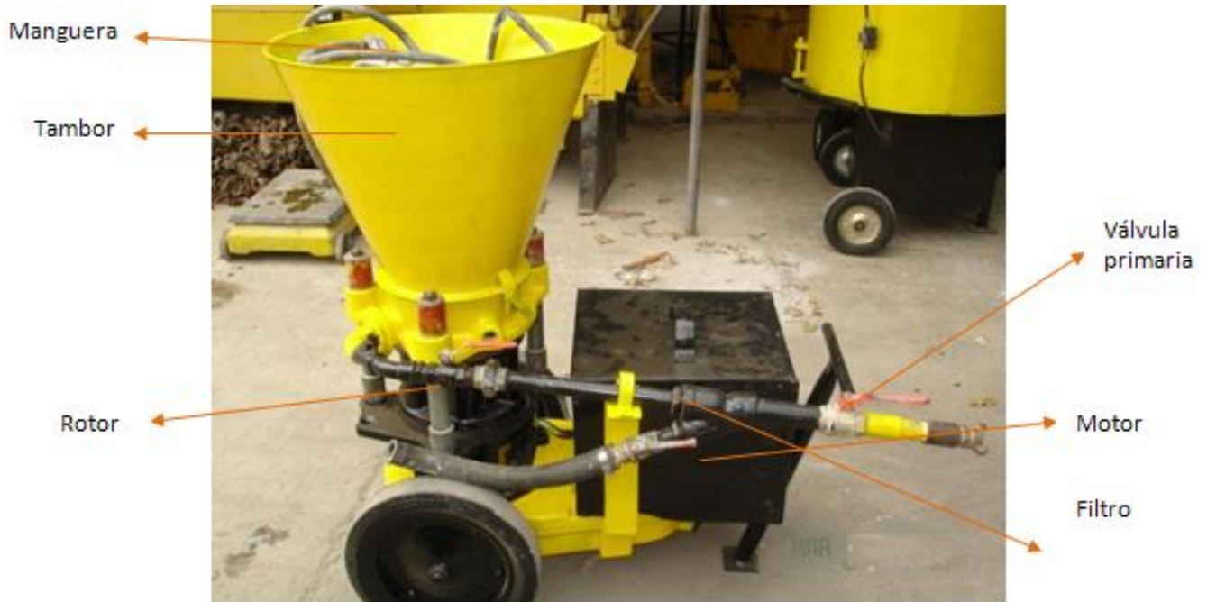
❖ Figura 10. Lanzadora de Concreto
